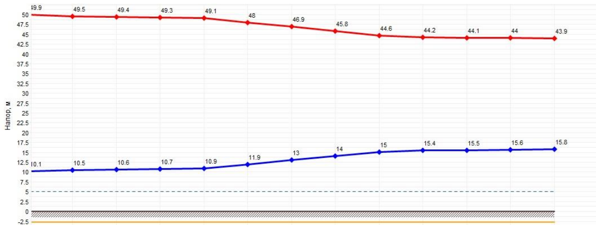
Рисунок 2.42 Пьезометрический график от Котельной п. Нагорный до самого удаленного потребителя в аварийной ситуации здания детского сада
